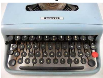
Le tastiere delle prime Lettera 22 avevano la z al posto dell'odierna w e viceversa.
